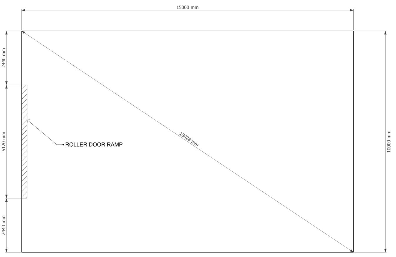
NOTE: ANY CONCRETE DRIVEWAYS, APRONS OR SURROUNDS MUST BE SET DOWN MINIMUM 50MM FROM SHED SLAB
